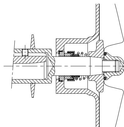
**¡ATENCIÓN!** Al montar el nuevo cierre, tener precaución de montar las piezas y las juntas con agua jabonosa a fin de facilitar el deslizamiento de las mismas, tanto de la parte fija en la tapa como de la parte giratoria en el eje.
